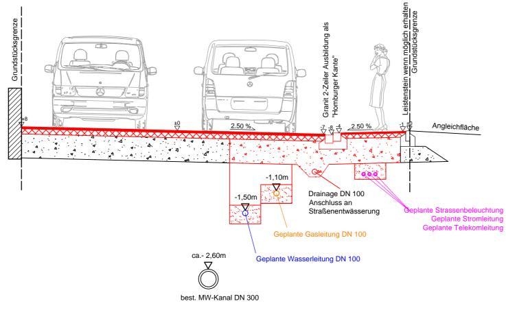
8.0 cm AC 22 T N 49.0 cm kombinierte Frostschutztragschicht 0/45
